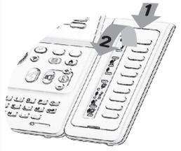
El teléfono puede estar equipado con una caja de extensión. Así dispondrá de teclas adicionales configurables como teclas de función, teclas de línea, teclas de llamada, etc. **Para colocar las etiquetas:** tire hacia usted de la lengüeta de soporte de la cubierta de las teclas y levante esta última. Sitúe la etiqueta bajo el bloque de teclas, en el lugar previsto a tal efecto y vuelva a colocar en su sitio la cubierta.
